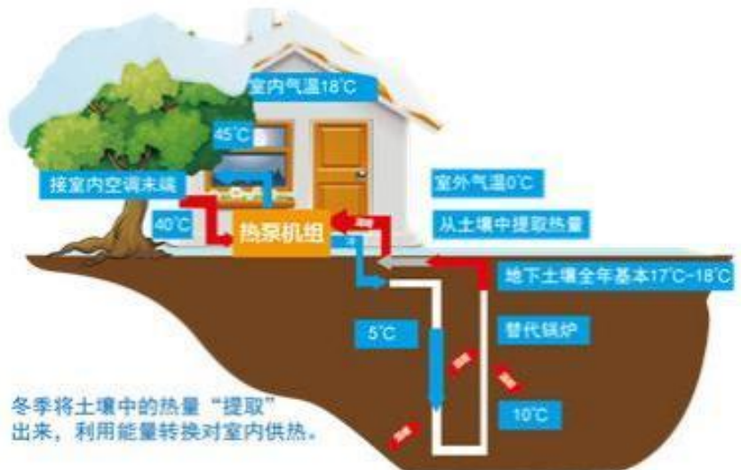
图 4 地源热泵系统（浅层地热能供热）
